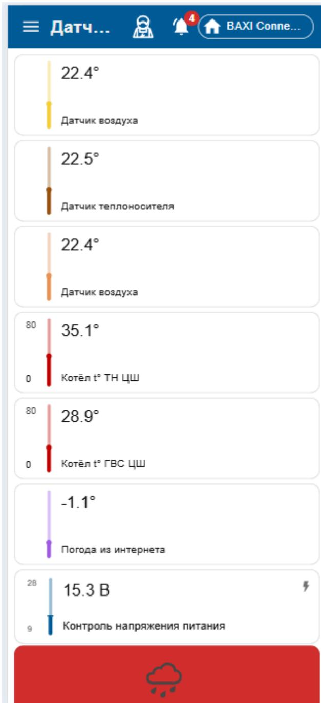
Вкладка, используемая для контроля данных от всех датчиков температуры, параметров считанных из цифровой шины котла, напряжения питания контроллера и датчиков, подключенных к его аналоговому входу.
