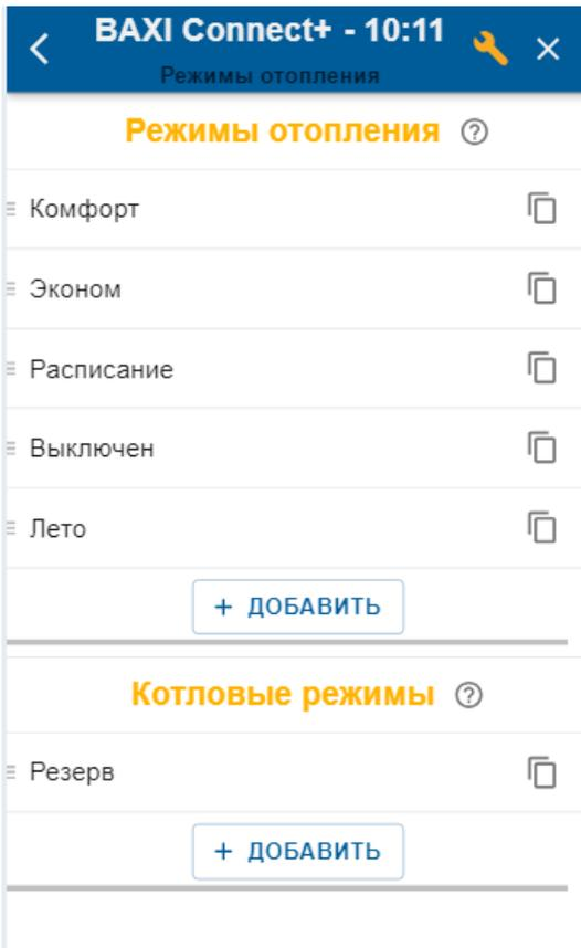
Заводской конфигурацией Контроллера предустановлены 5 Режимов отопления.
