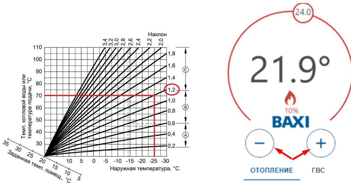
Значение параметра “запрос на тепло” при регулировании с ПЗА может быть задано только “**Требуемая теплоносителя**” или “**Требуемая теплоносителя+XX**”. Фактическая температура теплоносителя при этом будет определяться выбранной кривой и заданным способом регулирования:
