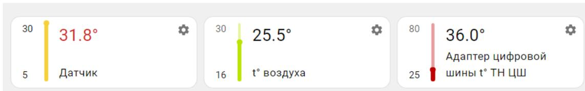
При отклонении температуры за пороговые значения, иконка датчика окрашивается в красный цвет и отображается порог, за который вышла фактическая температура.
