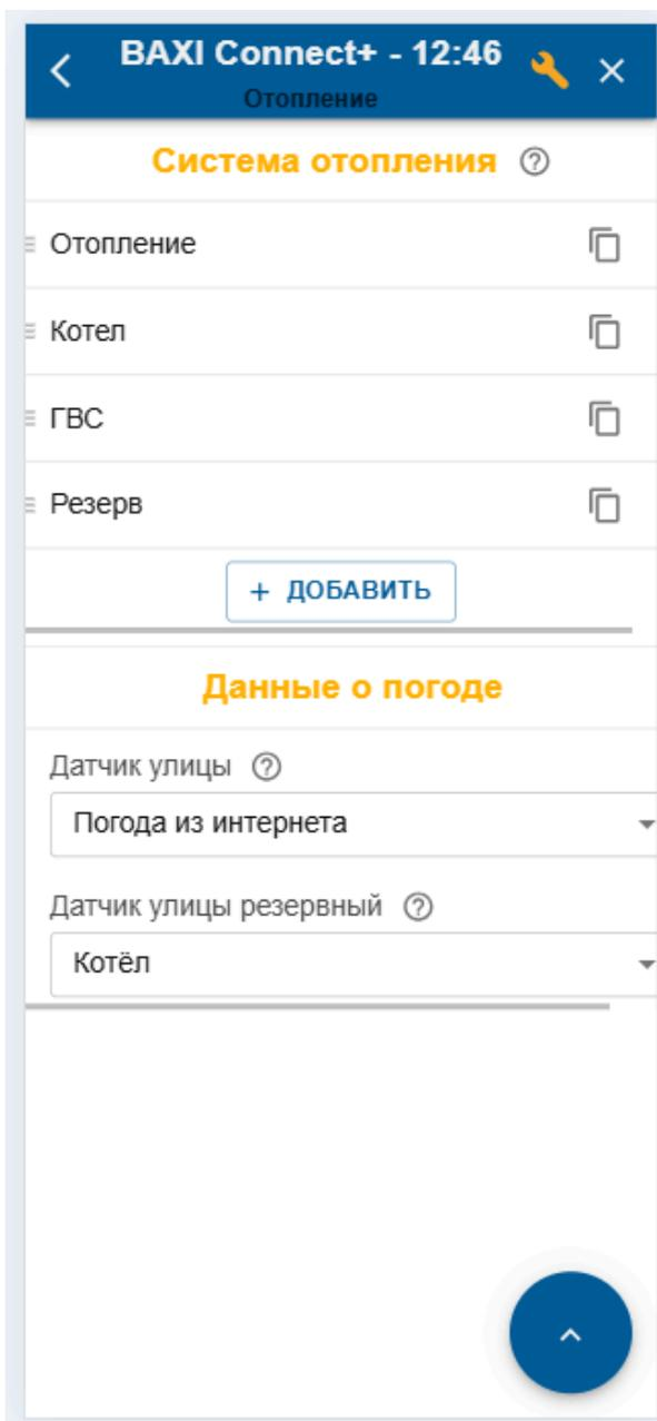
Основная группа настроечных параметров, влияющая на способ управления котлом, вид терморегулирования при работе на отопление, управление работой котла на ГВС, а также целевые температуры заданных режимов отопления.
