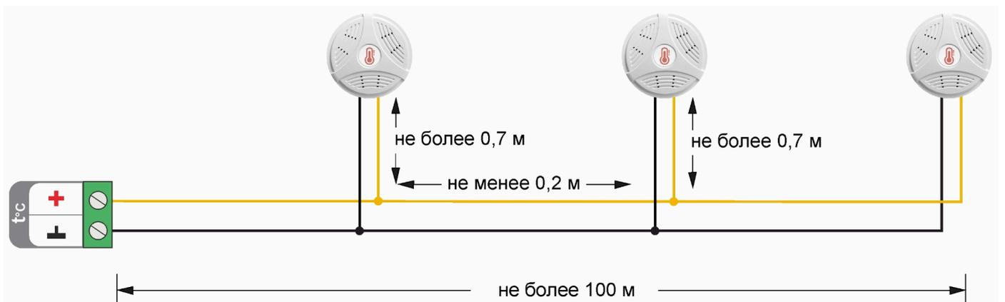
Подключение датчиков по трехпроводной схеме:
