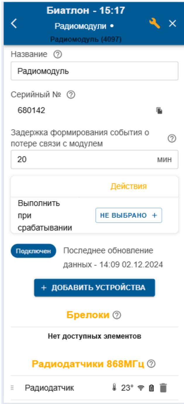
Радиодатчики ZONT используют шифрование данных и передают на Контроллер текущее состояние датчика, мощность радиосигнала в месте установки датчика и уровень заряда элемента питания.
