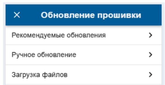
**Примечание:** При обновлении прошивки устройства у которого связь с сервером настроена по сети WI-FI нужно использовать “Медленный режим” обновления.
