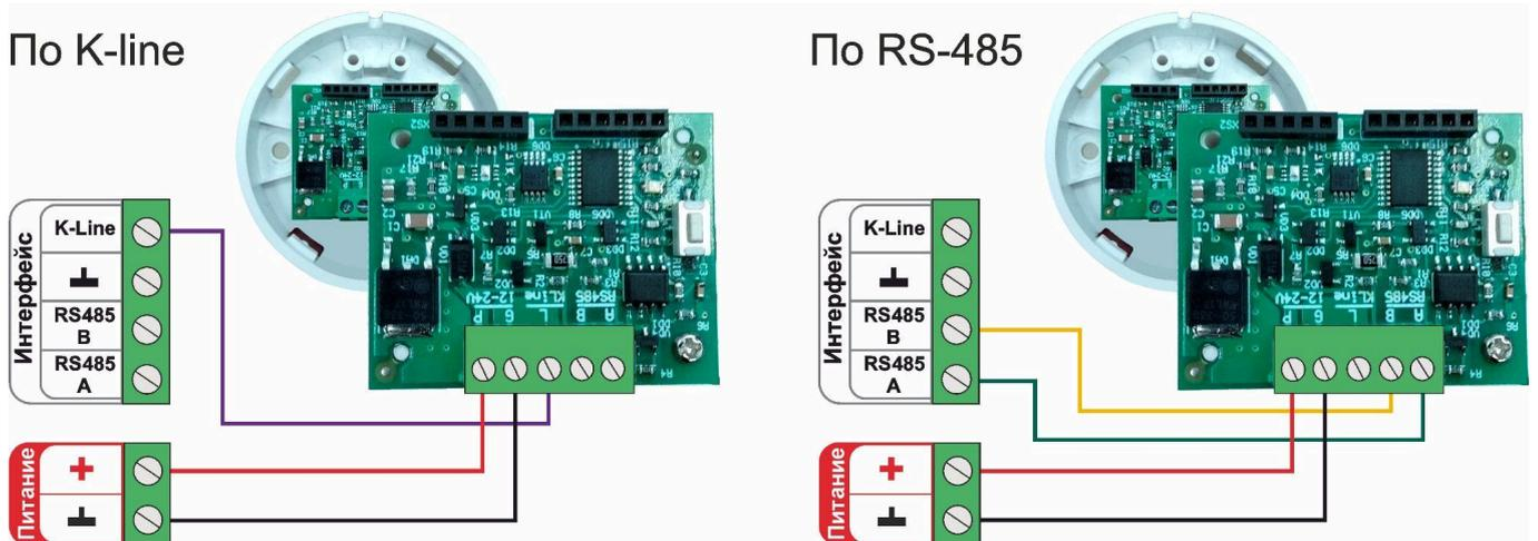
Допускается подключение только оригинальных датчиков температуры ZONT МЛ-778 и датчиков температуры / влажности МЛ-779. Сторонние датчики других производителей по интерфейсу RS-485 с Контроллером работать не могут.
