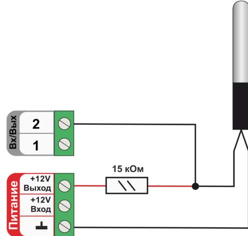
Для подключения датчика NTC-10 к аналоговому входу Контроллера необходимо использовать подтягивающий резистор 15 кОм с точностью 1%, подключенный между входом и клеммой питания “+12 В”.
