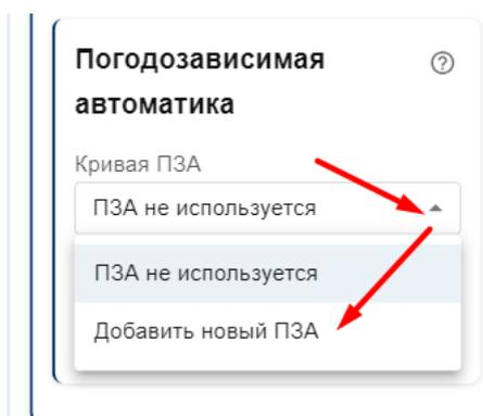
При регулировании с ПЗА “запрос на тепло” котлу соответствует значению температуры теплоносителя из выбранной “Кривой ПЗА”.
