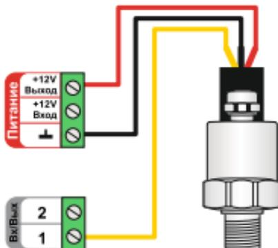
**3.3 Подключение датчика протечки**
