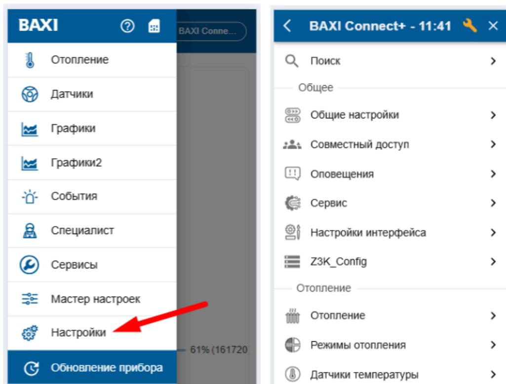
Конфигурацию контроллера частично можно изменять в ручном режиме, не используя “Мастер настройки”, с помощью настроечных параметров доступных на вкладке “**Настройки**”.
