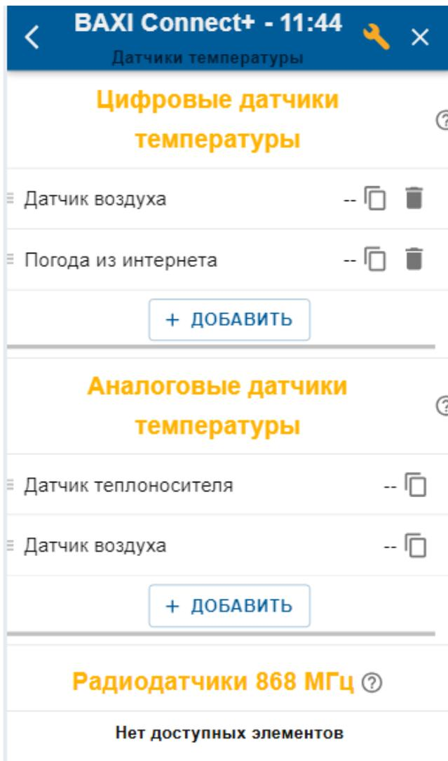
**Аналоговые датчики температуры** из комплекта Контроллера подключаются ко входам NTC. Чтобы датчики и их показания отображались в конфигурации Контроллера, надо проверить и при необходимости указать к какому входу NTC подключен каждый датчик. Для этого нужно “Добавить” датчик в ручном режиме ввода.
